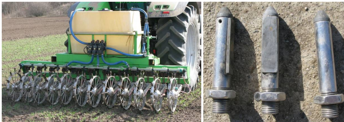
Obrázek 4: (A) Injektážní aplikátor GFI 3A s aplikačními hroty (Kozlovský, 2011)
